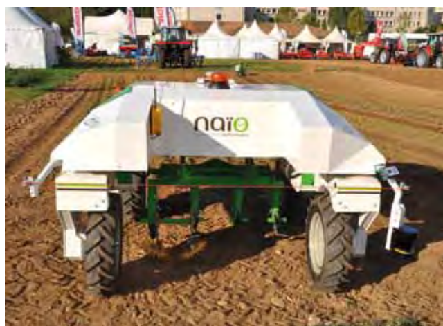
Der Naïo Dino kann autonom eine ganze Beetbreite bearbeiten (© Christian Hirschi, FiBL)
