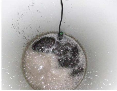
Abb. 2: Belüftetes VKE mit Heizstab
