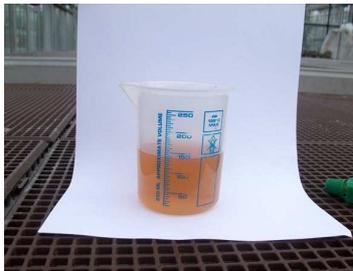
Abb. 13: Durch Salzfrei Filter gefiltertes VKE
